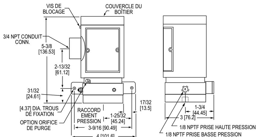
Le pressostat différentiel modèle H3 actionne un ou deux micro-contact unipolaire SPDT ou bipolaire DPDT en réponse à la pression croissante et décroissante de gaz ou liquides compatibles. Quatre gammes de pressions sont disponibles suivant les seuils jusqu'à 13780 mbar. Tous les modèles sont appropriés pour les zones à risques et comportent un boîtier étanche comme décrit dans le tableau ci-après. Bien lire complètement les instructions avant installation et utilisation.
